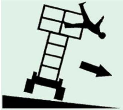
Figura 2 Vuelco del equipo por falta de estabilidad
